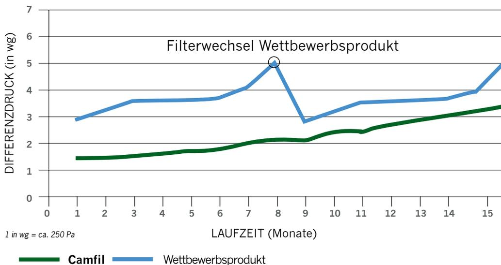
Beschleunigte Labortests (Abb. 1) belegen, dass HemiPleat-Filterpatronen von Camfil APC dauerhaft mit einem geringeren Druckabfall arbeiten als Filter der Marktbegleiter und eine längere Lebensdauer erzielen. Die offene Faltung der HemiPleat Filter ermöglicht eine 100%-ige Mediennutzung sowie eine vollständige Abreinigung der Stäube in den Sammelbehälter.
